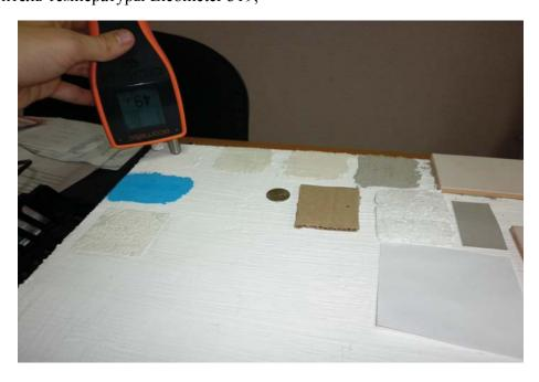
Рис. 1.2 — Измерение температуры на поверхности теплоизоляционного слоя Корунд®
