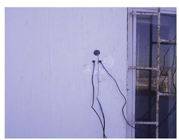
Рис. 4.3 — Измерение плотности теплового потока q, температуры поверхности  $\tau \kappa$  "Корунд $\mathbb{R}$ "
