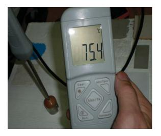
Рис. 1.1 — Замер температуры на поверхности теплоизоляционного слоя Корунд® разными приборами.
