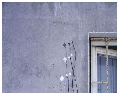
Рис. 4.2 — Измерение плотности теплового потока q, температуры поверхности  $\tau^{\kappa/6}$  керамзитобетонной стеновой панели
